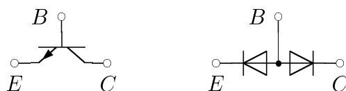
Abbildung 1.35: NPN-Transistor kann durch zwei Dioden nachgebildet werden
