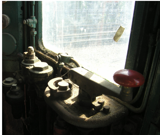
Abbildung 12.10: A „dead man's handle“ on a suburban train
